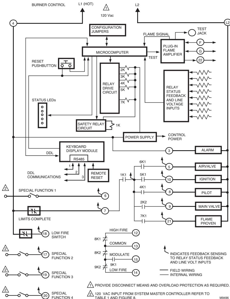
Fig. 8—RM7888A wiring diagram.
